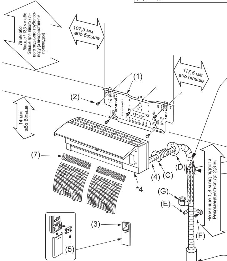
Якщо стіна пустотна, щоб запобігти контакту з'єднувального проводу для внутрішнього/зовнішнього блока (A) з металевими деталями в стіні та його пошкодженню гризунами, необхідно застосувати гільзу для проходу через стіну (C).
