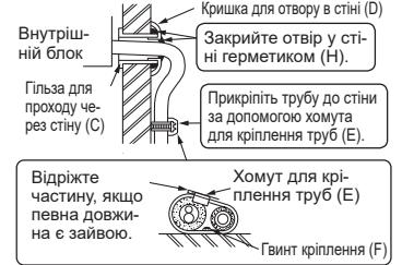
Після випробування на герметичність щільно накладіть ізоляційний матеріал для забезпечення відсутності щілин.
