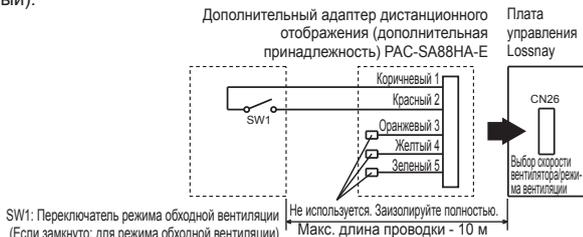
SW1: Переключатель режима обходной вентиляции (Если замкнуто: для режима обходной вентиляции)
