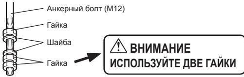
[При использовании (подготовленных заказчиком) виброизоляционных шайб]
