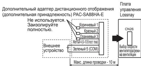
Для изменения скорости вентилятора входным сигналом 0–10 В пост. тока. Электрическая схема должна соответствовать рисунку выше. Для получения более подробной информации см. настройки функции № 63.
