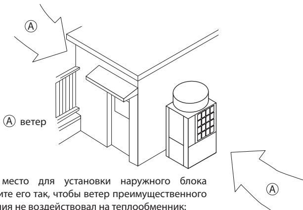
Выбирая место для установки наружного блока расположите его так, чтобы ветер преимущественного направления не воздействовал на теплообменник: расположите блок под прикрытием строительных конструкций.
