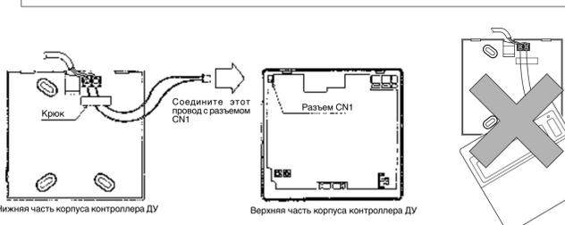
(7) Установите верхнюю часть корпуса. Сначала насадите верхнюю часть корпуса на два верхних выступа, а затем установите как показано справа.
