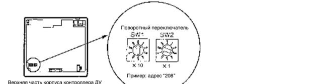
**ВНИМАНИЕ!** Контроллер группового ДУ может иметь адрес от 201 до 250. 100 зафиксировано на "2".
