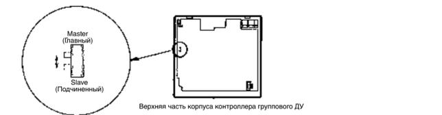
(6) Соедините этот разъем нижней части корпуса с разъемом CN1 верхней части корпуса.
