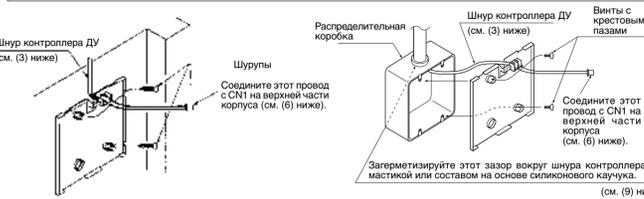
(3) Соедините шнур контроллера ДУ с клеммной коробкой в нижней части корпуса. Правильно, в соответствии с показанным справа рис., выполните подсоединения.
