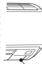
Переключатель аварийного управления (Е.О. SW)
