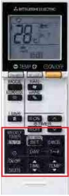
Таймер дозволяє задавати до 4 дій<sup>1</sup> впродовж дня: вмикання/вимикання та зміна цільової температури.
